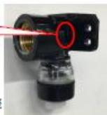
気密テスト0.3MPa（水圧テストの事前テストとして）を実施したところ、多数の座付き水栓エルボから漏水が発生した。
